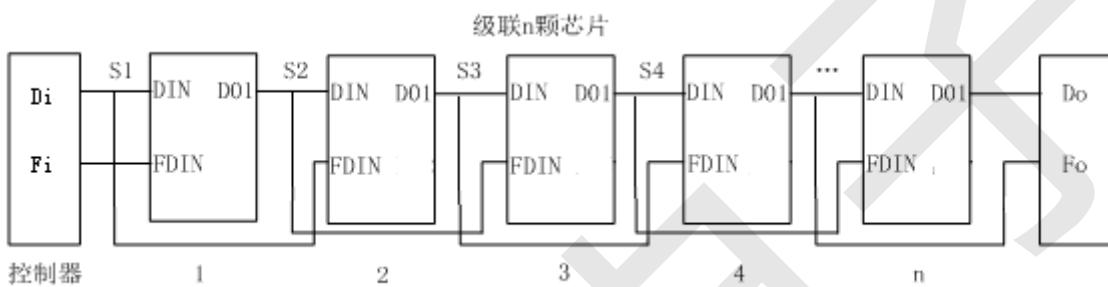
其中S1 为控制器Di端口发送的数据，S2、S3、S4 为级联LB1934A转发的数据。
