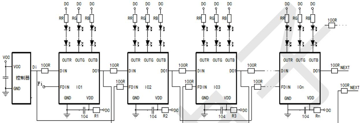
为防止产品在测试时带电插拔产生的瞬间高压导致芯片信号输入输出引脚损坏，应该在信号输入及输出脚串接100Ω保护电阻。此外，图中各芯片的104退耦电容不可缺少，且走线到芯片的VDD和GND脚应尽量短，以达到最佳的退耦效果，稳定芯片工作。另外第一个点控制器只需接DIN端口即可，FDIN端口可悬空；另若不需要断点续传功能，所有FDIN悬空即可。
